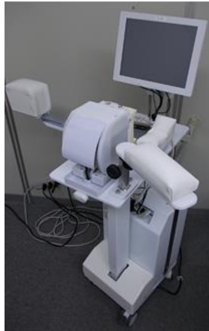
図1 製作した短時間法 FMD 計測装置および国内薬事申請書
