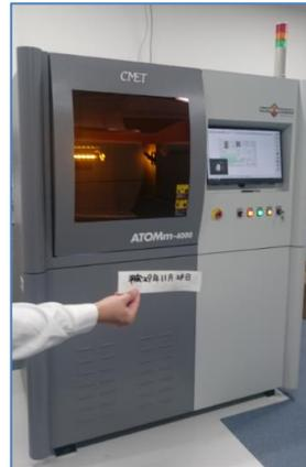
Fig.) シーメット株式会社製 光造形機
