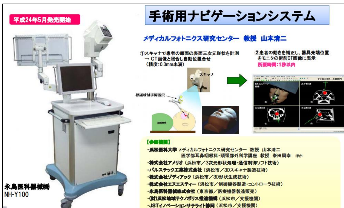
図 1 白色光表面三次元形状計測装置による内視鏡手術ナビゲーター
