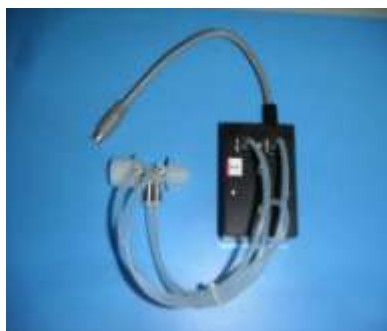
図 5. 呼吸マルチセンサ（差圧式）
